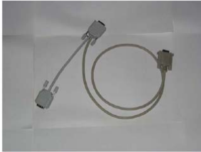
Figura 11 Splitter del cable serial que provee datos tanto al GPS y AIS en un solo puerto.
