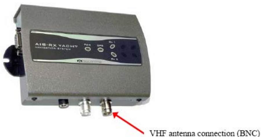
Figura 6 Conexión de la antena VHF
