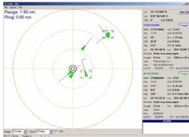
Figura 17 Ejemplo de cómo el AIS es presentado en AIS YATCH.
